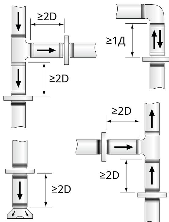
Рис. 3. Monteringsalternativ samt raksträckekrav.
