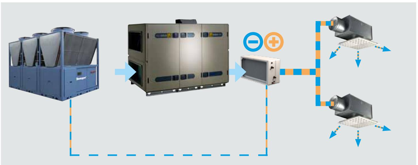
*Воздухоподготовительный агрегат использует большую часть года бесплатный холод наружного воздуха. При потребности в дополнительном охлаждении либо нагреве, многофункциональная холодильная машина обеспечивает комбинированный теплообменник холодной и теплой водой*
